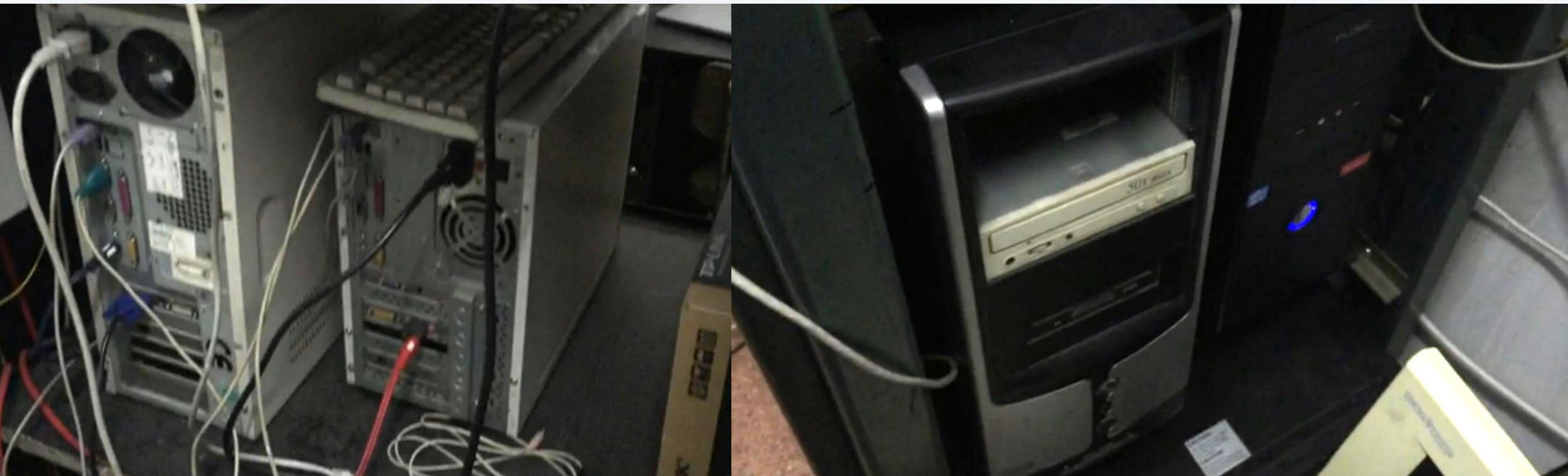
Serwery w serwerowni przygotowane z komputerów konsumenckich
