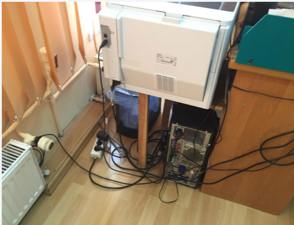
Brak standaryzacji komputerów klasy PC, brak logicznego okablowania
